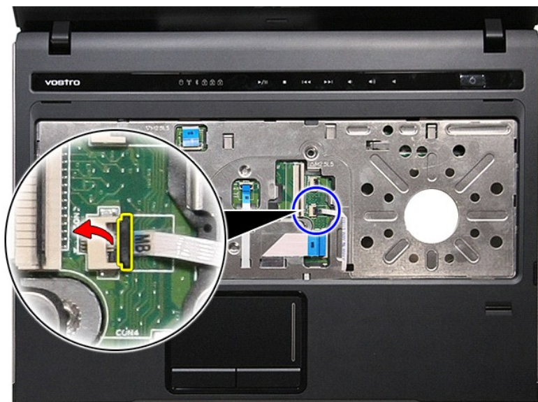
16. Deschideți clema ce fixează cablul cititorului de amprente de placa de sistem.
